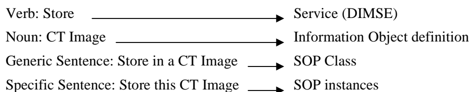
Fig. 2.7 Diagram demonstrující analogii mezi vytvářením věty a vytvářením DICOM SOP třídy.
