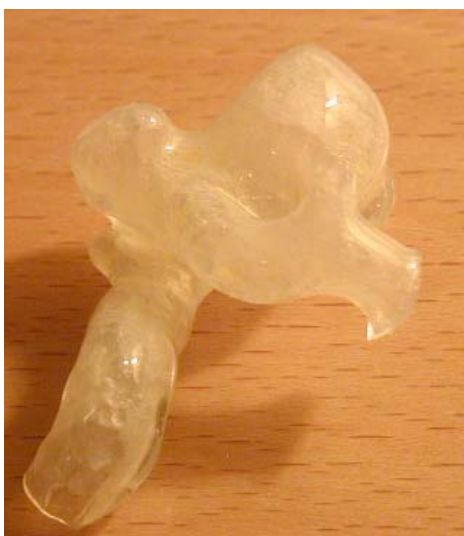
Obr. 5 Reálný silikonový model mozkových tepen vytvořený na základě CT/MR dat
