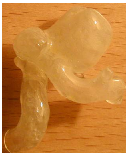
Obr. 5 Reálný silikonový model mozkových tepen vytvořený na základě CT/MR dat
