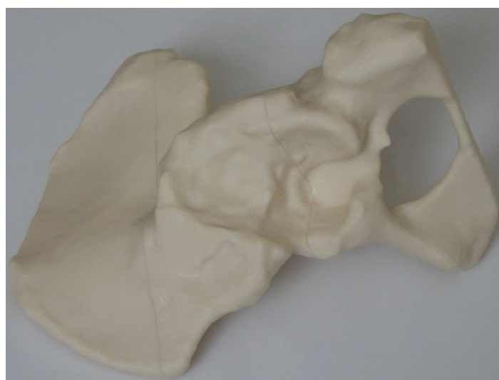
Obr. 7 Reálný model části pánve vytvořený na základě CT dat pro aplikaci v ortopedii ve spolupráci s Úrazovou nemocnicí v Brně.
