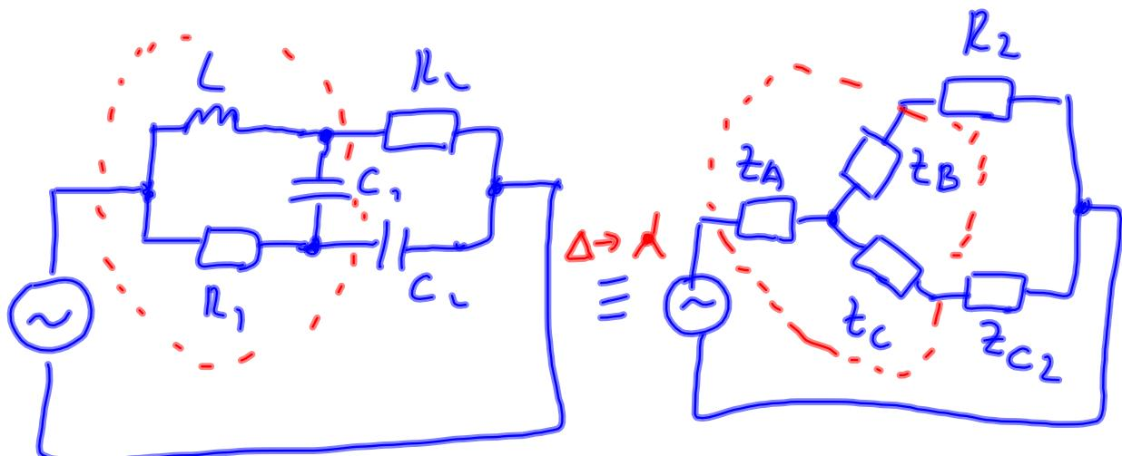
$$z_4 = \frac{z_L \cdot R_1}{z_L + R_1 + z_{C_1}} \in \mathbb{C}$$
