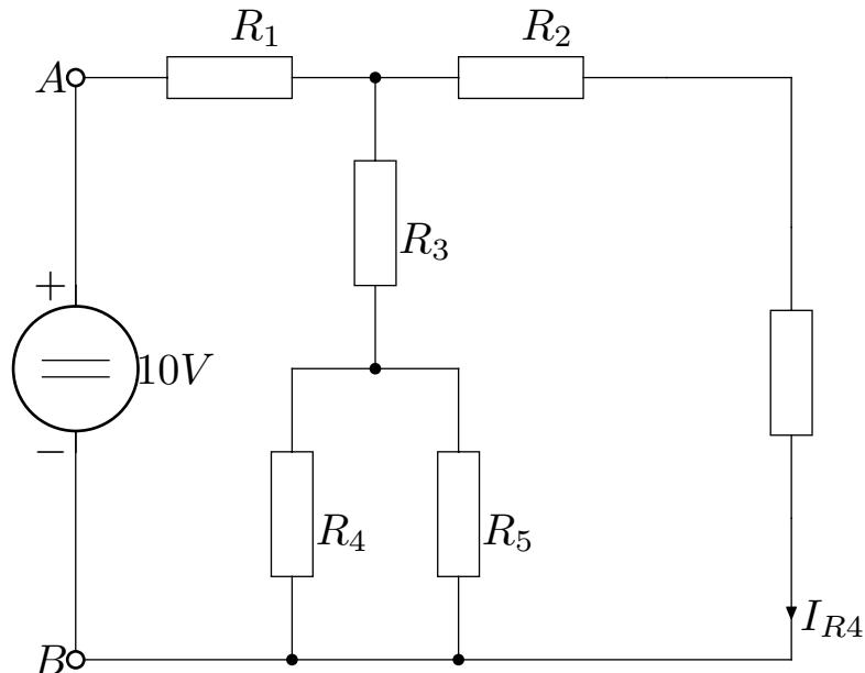
**Př.D10:** Určete maximální hodnoty odporu  $R_2$  tak, aby  $U_{R2}$  mělo hodnotu  $0,5V$ .
