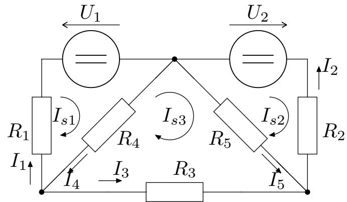
$$\begin{pmatrix} R_1 + R_4 & 0 & -R_4 \\ 0 & R_2 + R_5 & -R_5 \\ -R_4 & -R_5 & R_3 + R_4 + R_5 \end{pmatrix} \cdot \begin{pmatrix} I_{s1} \\ I_{s2} \\ I_{s3} \end{pmatrix} = \begin{pmatrix} U_1 \\ -U_2 \\ 0 \end{pmatrix}$$
