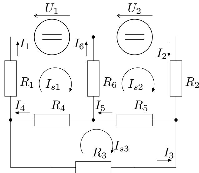
$$\begin{pmatrix} R_1 + R_4 + R_6 & -R_6 & -R_4 \\ -R_6 & R_2 + R_5 + R_6 & -R_5 \\ -R_4 & -R_5 & R_3 + R_4 + R_5 \end{pmatrix} \cdot \begin{pmatrix} I_{s1} \\ I_{s2} \\ I_{s3} \end{pmatrix} = \begin{pmatrix} U_1 \\ U_2 \\ 0 \end{pmatrix}$$
