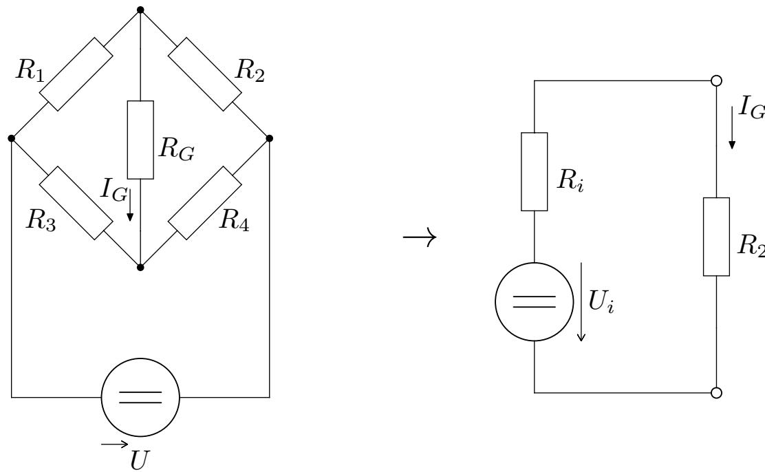
$$\begin{pmatrix} R_3+R_4 & 0 \\ 0 & R_1+R_2 \end{pmatrix} \cdot \begin{pmatrix} I_a \\ I_b \end{pmatrix} = \begin{pmatrix} -U \\ U \end{pmatrix}$$
