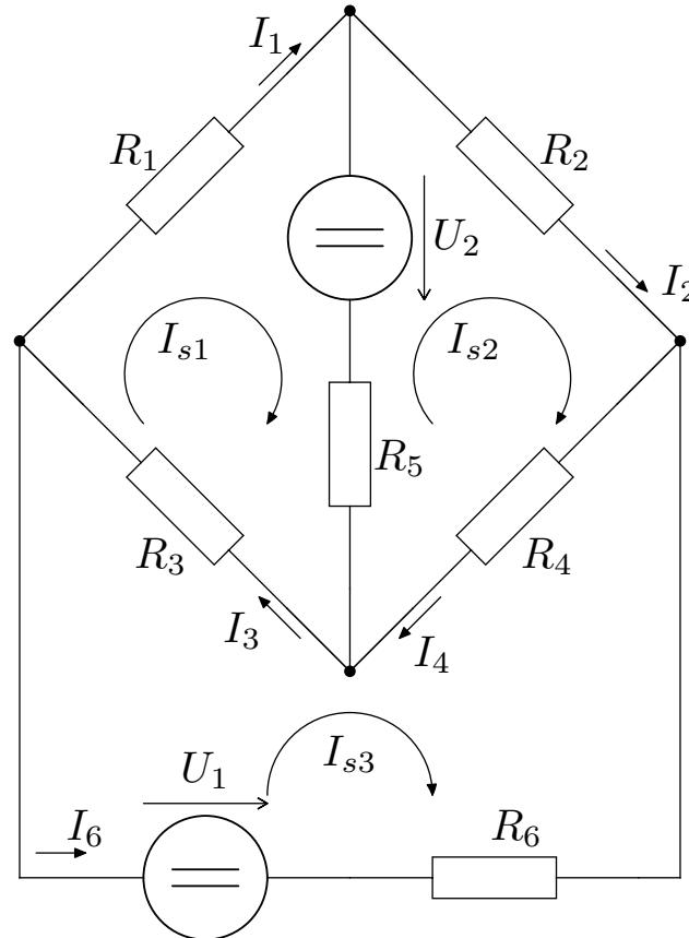
$$\begin{pmatrix} R_1 + R_3 + R_5 & -R_5 & -R_3 \\ -R_5 & R_2 + R_4 + R_5 & -R_4 \\ -R_3 & -R_4 & R_3 + R_4 + R_6 \end{pmatrix} \cdot \begin{pmatrix} I_{s1} \\ I_{s2} \\ I_{s3} \end{pmatrix} = \begin{pmatrix} -U_2 \\ U_2 \\ U_1 \end{pmatrix}$$
