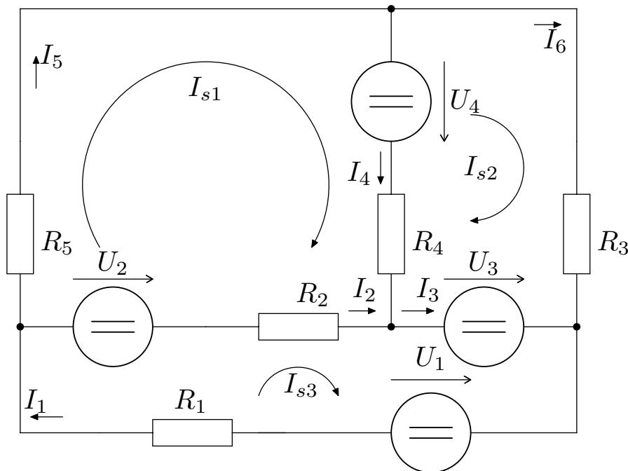
$$\begin{pmatrix} R_2 + R_4 + R_5 & -R_4 & -R_2 \\ -R_4 & R_3 + R_4 & 0 \\ -R_2 & 0 & R_1 + R_2 \end{pmatrix} \cdot \begin{pmatrix} I_{s1} \\ I_{s2} \\ I_{s3} \end{pmatrix} = \begin{pmatrix} U_2 - U_4 \\ U_3 - U_4 \\ U_1 - U_2 - U_3 \end{pmatrix}$$
