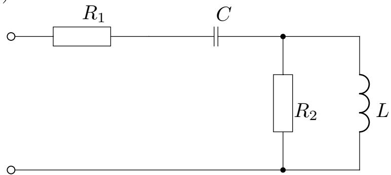
$$\hat{Z} = R_1 + \frac{1}{j\omega \cdot C} + \frac{R_2 \cdot j\omega \cdot L}{R_2 + j\omega \cdot L}$$
