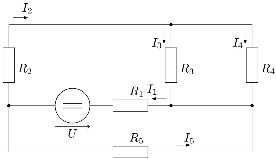
$$I_2 - I_3 - I_4 = 0 \Rightarrow I_2 = I_3 + I_4 = 1,25 + 1 = 1,25A$$
