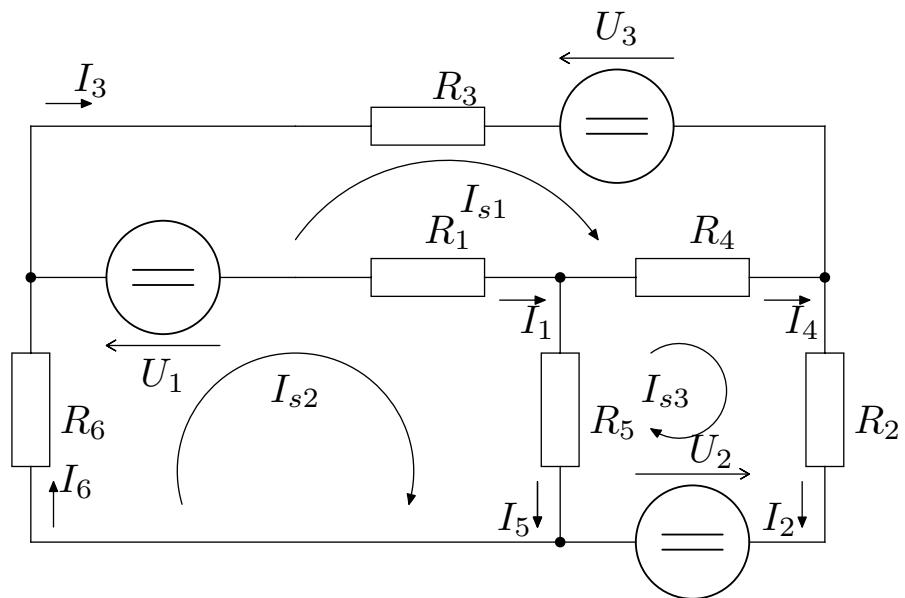
$$\begin{pmatrix} R_1 + R_3 + R_4 & -R_1 & -R_4 \\ -R_1 & R_1 + R_5 + R_6 & -R_5 \\ -R_4 & -R_5 & R_2 + R_4 + R_5 \end{pmatrix} \cdot \begin{pmatrix} I_{s1} \\ I_{s2} \\ I_{s3} \end{pmatrix} = \begin{pmatrix} U_3 - U_1 \\ U_1 \\ U_2 \end{pmatrix}$$
