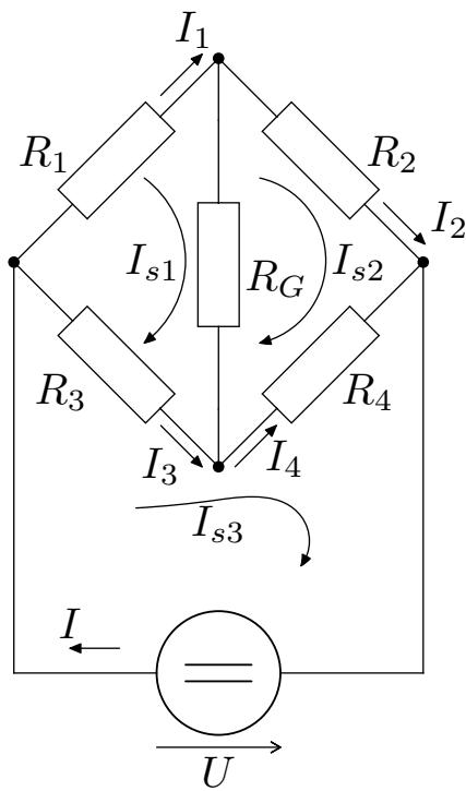
$$\begin{pmatrix} R_1 + R_G + R_3 & -R_G & -R_3 \\ -R_G & R_2 + R_4 + R_G & -R_4 \\ -R_3 & -R_4 & R_3 + R_4 \end{pmatrix} \cdot \begin{pmatrix} I_{s1} \\ I_{s2} \\ I_{s3} \end{pmatrix} = \begin{pmatrix} 0 \\ 0 \\ U \end{pmatrix}$$
