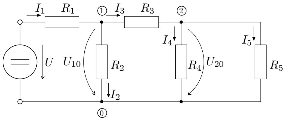
$$-I_1 + I_2 + I_3 = 0 \Rightarrow I_1 = I_2 + I_3 = 0,001 + 0,003 = 4mA$$
